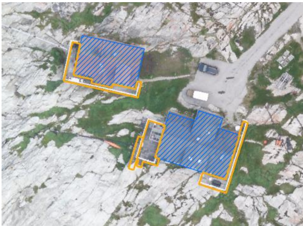
Figur 6. Eksempel på Bygningsdetalje (orange) ved bygning (blåskraveret).
